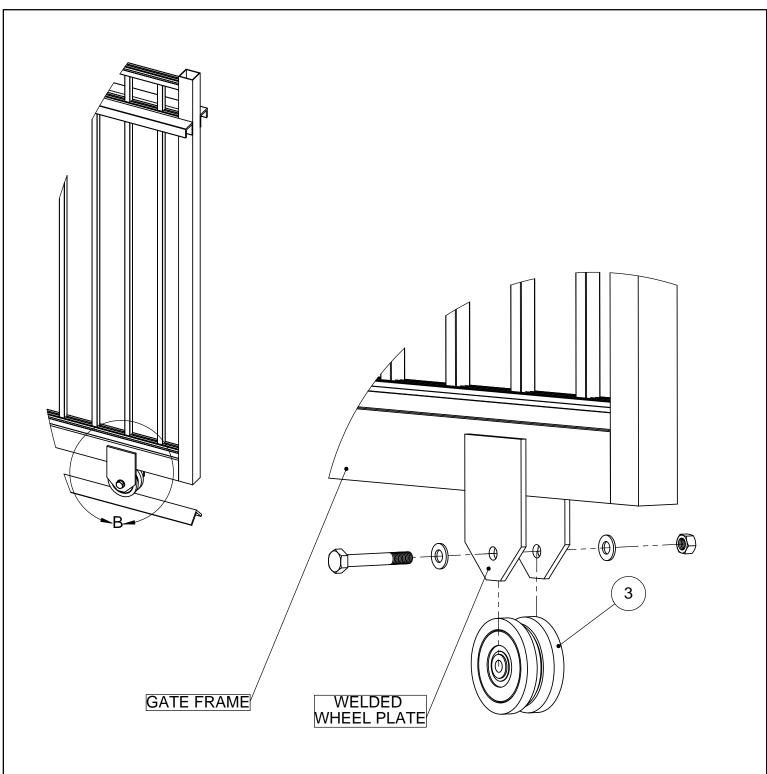
DETAIL B - V-GROOVE WHEEL SCALE 1:4
